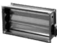
Tesné lamelové klapky so servopohonom slúžia najčastejšie k uzatváraniu štvorhranného vzduchotechnického potrubia riadením systémom. Obe koncové polohy (otvorené - zatvorené) je možné obmedziť mechanickými dorazmi na servopohone. Servopohon je u klapiek LKS.../24 pre napätie 24V AC/DC, u klapiek LKS.../230 pre napätie 230V AC. Typ klapky podľa napäcia servopohonu je nutné vybrať podľa pripojenia k riadiacemu systému.
