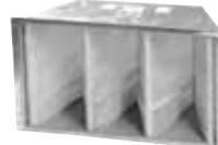
Filtračné vložky VF3 (trieda filtrácie G3) sú určené pre kazety filtrov VFK. Vložka je tvarovo vystužená a je osadená a utesnená v kazete z pozinkovaného plechu. Vložky sú len obmedzene regenerovateľné. Vo vložkách sa vymieňa iba filtračná tkanina (pásy VF3N).
