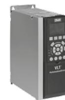
Frekvenčné meniče RFFM sú naprogramované pre použitie so strešnými ventilátormi RF a ovládačom ORe 5, príp. na ovládanie signálom 0–10 V. Údaj v závorke odpovedá napájaciemu /vstupnému/ napätiu meniča, pričom u variant na 1 x 230 V je nutné prepojenie elektromotora na prevádzku s napäťom 3 x 230 V.
