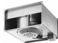
Radiálne potrubné ventilátory RP s dopredu zahnutými lopatkami majú jednofázové (E) a trojfázové (D) elektromotory s tepelnou poistkou vyvedenou do svorkovnice. Ventilátory musia byť za prevádzky chránené ochranným prvkom ovládaným kontaktom termopoistiek (termokontaktov TK). Ventilátory sú napäťovo regulovalné pomocou regulátorov TRN alebo TRRE/TRRD.
