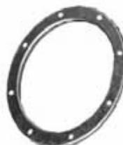
Protiprírubu GK je možné použiť pre ukončenie kruhového vztu potrubia v mieste napojenia na sanie ventilátorov RF (GK sa nepoužíva pokiaľ je RF osadený na strešnom nástavci), RQ príp. RQ Ex. Vŕtaná protipríuba je z pozinkovaného plechu.
