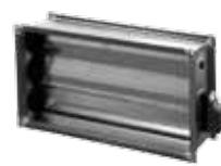
Tesné lamelové uzatváracie a regulačné klapky LKSX sa najčastejšie používajú ako zmiešavacie, vstupné a výstupné uzatváracie - regulačné. Obe koncové polohy (otvorené - zatvorené) je možné obmedziť mechanickými dorazmi na servopohone. Ovládanie je motorické servopohonom s proporcionálnou reguláciou polohy s napájaním 24 V AC/DC a riadiacim signálom 0–10 V DC.
