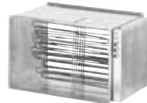
Elektrické ohrievače sú určené k ohrevu vzduchu vo vzduchotechnických zariadeniach. Ohrievače sa štandardne pripojujú k riadiacim jednotkám. Ohrievače sú osadené nerezovými vykurovacími tyčami o celkovom výkone uvedenom za lomítkom v kW. Plášť ohrievača je vyrobený z pozinkovaného plechu.
