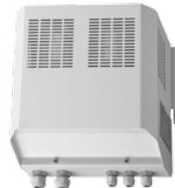
Päťstupňové, diaľkovo ovládané regulátory výkonu sú určené pre napäťovú reguláciu jednofázových a trojfázových ventilátorov. Číslo za názvom regulátora udáva max. povolenú prúdovú záťaž. Regulátory sú štandardne vybavené ochranou ventilátorov, ktorá je funkčná po pripojení termokontaktov (TK). Regulátory sa umiestňujú najlepšie do blízkosti ventilátoru a ich diaľkové ovládanie sa vyvedie 10-žilovým káblom vzdialému ovládaču.
