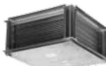
Doskový rekuperátor HRV je konštruovaný pre zaradenie do systému vzduchotechnických zariadení ako s paralelným vedením trasy prívodu a odvodu vzduchu, tak kolmým a šikmým pod uhlom 45° a ich rôznymi kombináciami. Prietok vzduchu rekuperátora je krízový. Rekuperátor je osadený teplovýmennou vložkou z tenkých Al plechov. S rekuperátorom sa dodáva súprava na odvod kondenzátu.
