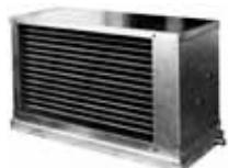
Vodné chladiče CHV s izoláciou proti kondenzácii sú vyrobené z Cu ruriek s presahom navlečenými Al lamelami. Plášť chladiča je štandardne vyrobený z pozinkovaného plechu a obsahuje tiež plastový eliminátor kvapiek a vaňu odvodu kondenzátu. Vodné chladiče sa bežne regulačnými zmiešavacími uzlami SUMX. CHV sú dodávané štandardne v trojradom ľavom prevedení pri pohľade v smere prúdenia vzduchu. Prevedenie iného typu (pravé, bez eliminátora, príp. dvojradové) je možné na objednávku.
