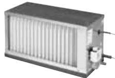
Eliminátory kvapiek konštrukčne vychádzajú z chladičov, miesto výmenníkov ale obsahujú prázdny priestor /pre stabilizáciu prúdenia príp. odkvapkávanie kondenzátu, pred priechodom vzduchu do lamel eliminátora/. Je možné ich použiť ako prídavné eliminátory pri veľkom vzniku kondenzátu na chladičoch alebo rekuperátoroch HRV. EKP sú štandardne dodávané v prevedení lavom pri pohľade v smere prúdenia vzduchu. Prevedenie pravé je možné na objednávku.
