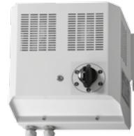
Päťstupňové regulátory výkonu sú určené pre napäťovú reguláciu jednofázových a trojfázových ventilátorov. Číslo za názvom regulátora udáva max. povolenú prúdovú záťaž. Regulátory nie sú vybavené ochranou (je nutné použiť ochranné relé STE, STD) a ich ovládanie je iba ručné priamo na skriní regulátora. Vo väčšine prípadov je výhodnejšie použiť dokonalejšie regulátory TRN s diaľkovým ovládaním..
