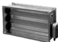
Tesné lamelové uzatváracie klapky LKSF s bezpečnostnou funkciou sa najčastejšie používajú ako vstupné uzatváracie. Ovládanie je motorické servopohonom pre napätie 230V AC. Servopohon klapku uzavrie havarijnou pružinou i pri výpadku napájania, čím sa znížuje riziko zamrznutia vodného ohrievača.
