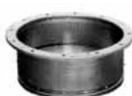
Podlaková klapka sa montuje priamo na sanie strešného ventilátora. Po vypnutí ventilátora uzatvára sanie a tým zabraňuje samočinnému prúdeniu vzduchu a tepelným stratám. Klapku VS je možné použiť pre priamu montáž do nástavcov NK, NDH.
